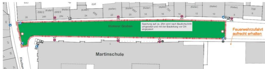
Die Maßnahme beginnt mit dem **Ausbau der Oberflächenbeläge sowie der Bordsteine**. Bis zum Schulbeginn nach den Osterferien werden diese Flächen wieder provisorisch hergestellt, so dass ein geordneter Zugang zu den Wohnhäusern und den Schulen gewährleistet ist.
