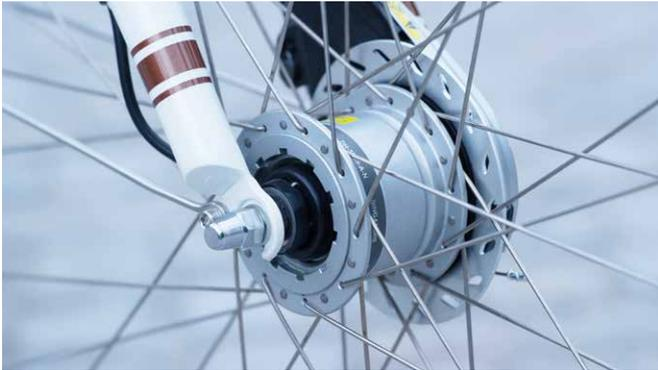
**Nabendynamos** sind zuverlässiger und wartungsärmer als die klassischen Seitenläufer. Da Nabendynamos permanent mitlaufen, eignen sie sich ideal für ein Fahren mit Tagfahrlicht. Die geforderten 10 Lux Minimalleistung können i.d.R. nur mit LED-Scheinwerfern erreicht werden. Scheinwerfer mit Glühlampen erreichen bis zu 4 Lux, Halogenstrahler bis zu 7 Lux. Eine Nachrüstpflicht für alte Räder gibt es aber nicht.
